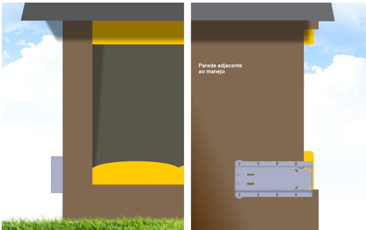
Figuras 01 y 02. Instalación del soporte de cortina lateral.
