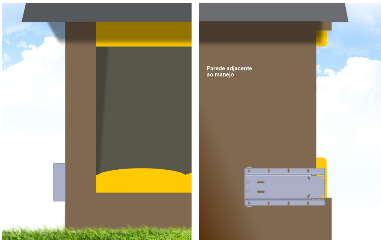
Figuras 01 e 02. Instalação do Suporte para Cortina Lateral.
